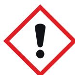
SGH07 Danger pour sensibilisation cutanée, inhalation, corrosion ou irritation des yeux
